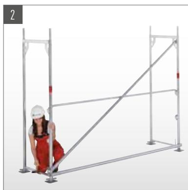
Mise en place d'une diagonale et d'un contre-ventement horizontal (seulement dans la travée des diagonales).
