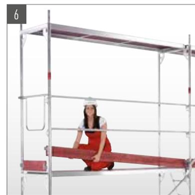
Montare il telaio e l'impalcato dello strato successivo, appendere i sostegni diagonali, le ringhiere e le tavole di punta.
