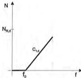
Bild 4: bilineare Federkennlinie
