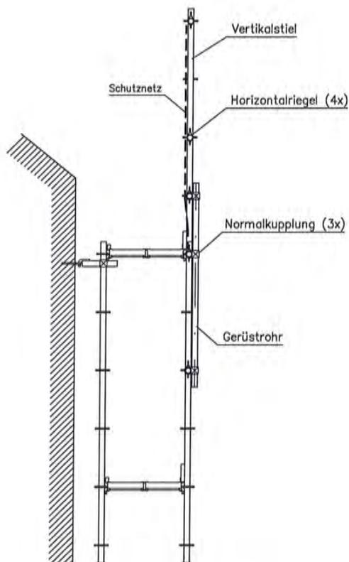
Schutznetz: DIN EN 1263-1, Maschenweite 100 mm
