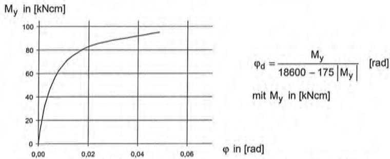
**Bild 4:** Drehfedersteifigkeit im Belagriegelanschluss in der vertikalen Ebene
