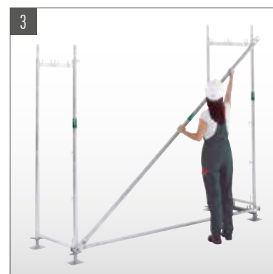
3 Diagonale über Kippstifte montieren.
