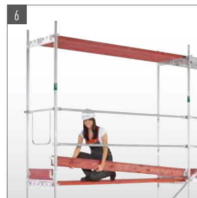
6 Vertikalrahmen und Beläge der nächsten Lage montieren, Diagonale, Geländer und Bordbretter einhängen.
