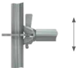
Vertikale Querkraft, Einzelanschluss: O-Riegel:  $V_{z,R,d} = \pm 38,3 \text{ kN}$
